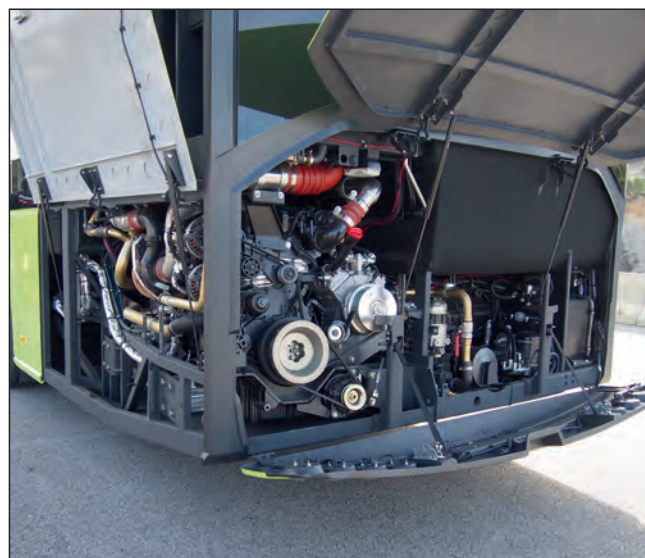
Links stehend im Heck: MX11-Sechszylinder von DAF
