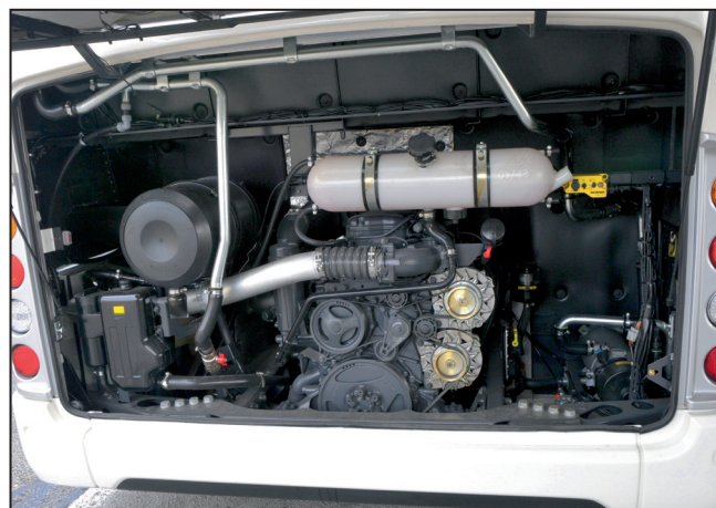
Euro 6-Spezialität aus Schweden: kräftiger Fünfzylinder mit SCR-only-Abgastechnologie
