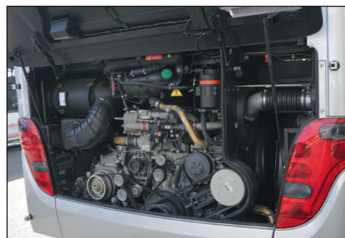
Das Kraftpaket im Heck: der wuchtige Reihensechszylinder bringt mehr Kraft auf die Straße als der hubraumstärkere Vorgänger-Diesel
