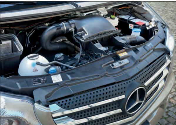
Neu: die vier- oder sechszylindrigen Dieselmotoren erfüllen mit Adblue-Eindüsung ins Abgas die Euro 6-Grenzwerte
