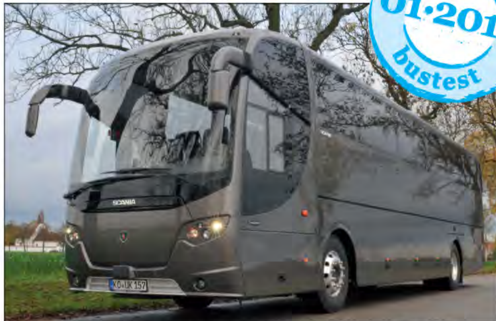
Scania OmniExpress aus Lahti: Zweiachser in Edelstahlbauweise, 12,4 m Länge für 49 Fahrgäste
