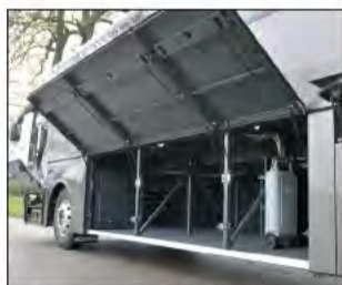
9,1 m 3 großer Kofferraum, separates Staufach über der Hinterachse für den Fahrer
