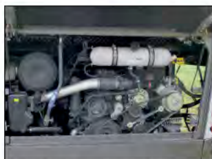
Mit 410 PS ohne Abgasrückführung: Dieser 12,7-l-Sechszylinder zielt vor allem auf den Fernlinienverkehr.
