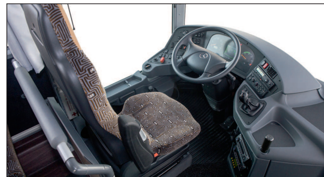
Mehr Schalter und mehr Komfortfunktionen im Integro, der die acht Gangstufen automatisch sortiert
