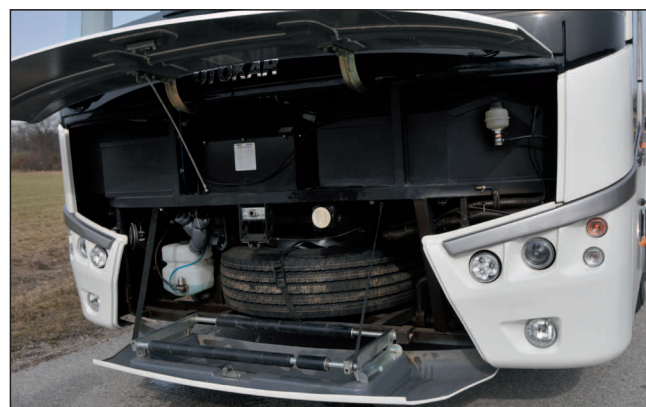
Servicefreundliche Front: Reserverad und Scheinwerfer sind mit wenigen Handgriffen erreichbar
