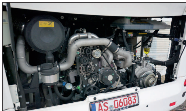
MAN-Triebwerk im Heck: mit 290 PS ist der 14-Tonner gut motorisiert
