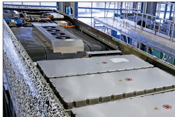
Einblick hinter die Dachblenden: Bis zu sechs Batteriemodule werden nahe der Vorderachse montiert und die Klimatechnik dahinter
