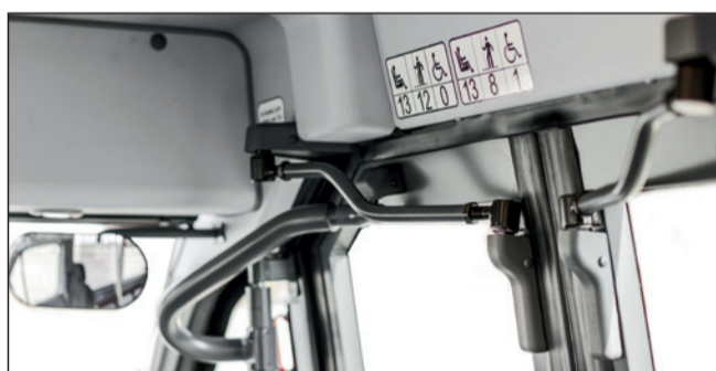
Die bessere Lösung: Die Türführung oben gewährt unbedingte Betriebssicherheit
