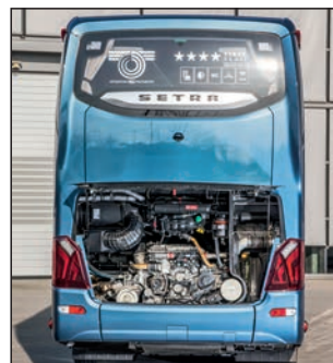
Sanfte Gewalt: Der OM 471-Sechszylinder im Heck stemmt sich mit niedrigen Drehzahlen vehement gegen Fahrwiderstände
