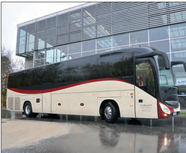
Ein Blickfänger: Der Iveco Magelys wirkt vergleichsweise filigran, ohne Dachklimaanlage kommt er mit 2,62 m Höhe aus
