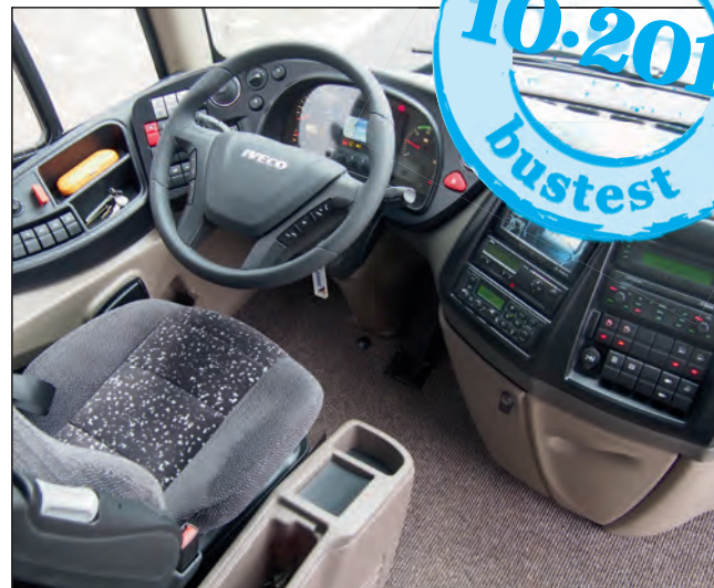
Klare Verhältnisse: Schalter und Bedienelemente sind funktional sortiert, an der Mittelkonsole aber schlecht zu greifen
